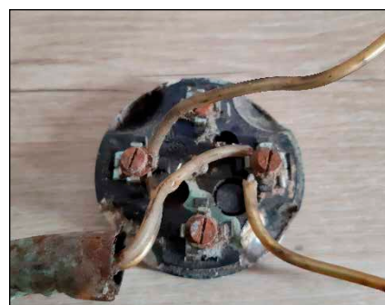
Bild 9: Worst Case-Schraubverbindungen in der HN-Verteilerdose
