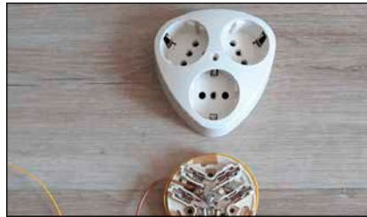
Bild 5: Laborvermessung von Steckdosen und Verteilerdosen verschiedener Baujahre 1950 bis 1980
