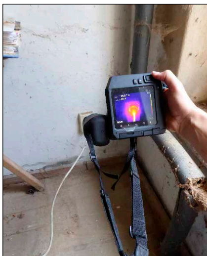
Bild 8: Vor-Ort-Messungen einer Steckdose mit Temperatursensor zum Temperaturverlauf und zur Kontrolle mit Thermographiekamera
